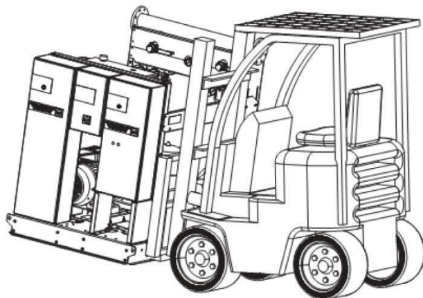
Рис. 3 Схема перемещения УПД к месту монтажа
