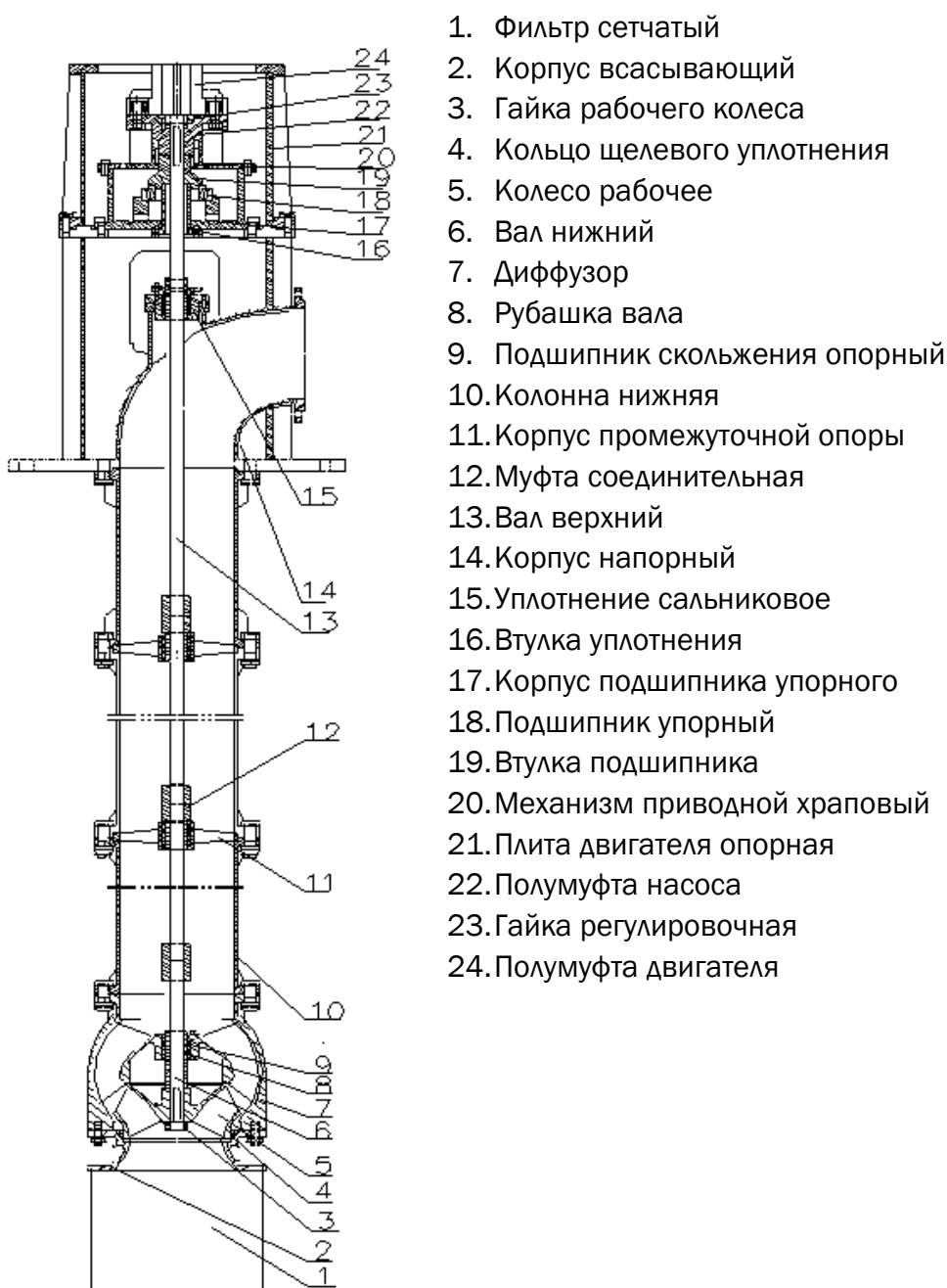
Рис. 21 Конструкция насоса VTP с открытым валом
