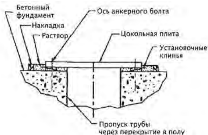
Рис. 6 Установка плиты по уровню
